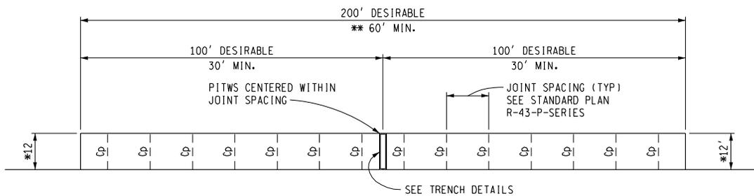
LONGITUDINAL GRADE THROUGHOUT TAPERS AND SCALE PAD SHALL BE IN ONE PLANE WITH A 0.2% MAXIMUM GRADE
